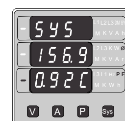
Tela : Sistema de ângulo de fase e fator de potência (3 fases 4 fios e 3 fios )
